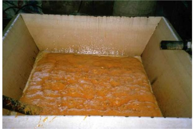
So erhält man den Zuckerrohrsafte. Er wird erhitzt, damit sich Kristalle bilden. Die Kristalle sind braun. Damit sie weiß werden, werden sie gefiltert und gereinigt.
