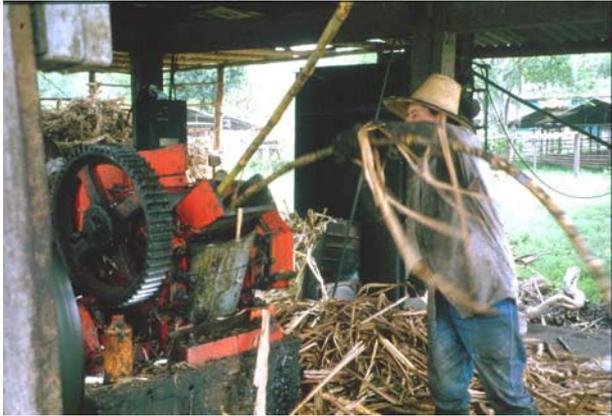
Die Blätter werden abgestreift und die Rohre in Mühlen zerquetscht.
